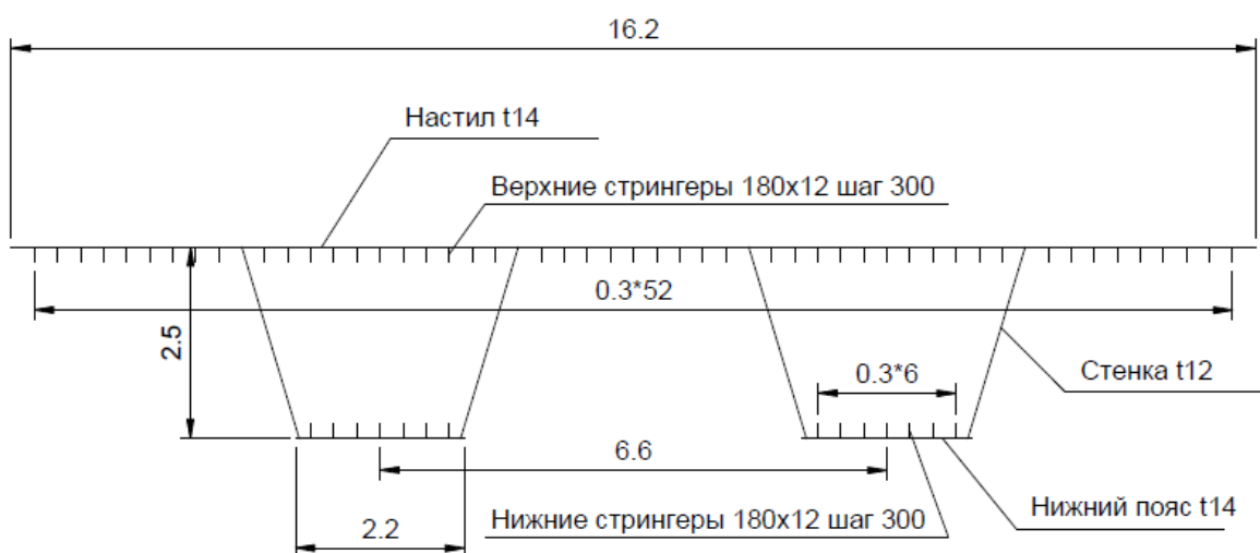
Рис. 102. Схема поперечного сечения пролетного строения.
